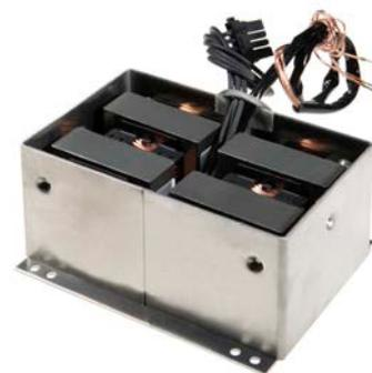
InTiCa Systems entwickelt und produziert AC-Filterdrosseln, Hochsetzsteller- und Boost-Drosseln, Hochfrequenztransformatoren und Induktivitätenmodule für Solar-Wechselrichter. InTiCa Systems hat sich hierbei auf den Leistungsbe- reich von 0-300 kW bei einer Schaltfrequenz von 16-50 kHz spezialisiert. Mittels eines eigenen Messplatzes zur Bestimmung der Verlustleistung können die Wickelgüter bereits in einem frühen Entwicklungsstadium optimiert werden.
